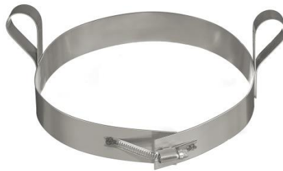
Rohrschelle mit Ablassösen (aus statischen Gründen nur bis DN 200)
